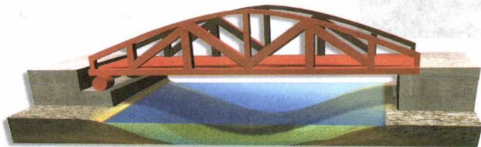
Установка моста на специальных катках
