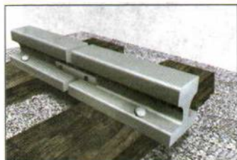
Стыки железных рельсов
